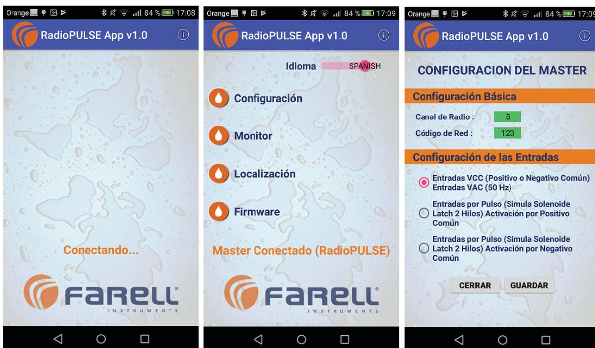
Una vez conectado, escoger **Configuración**, En **Configuración Básica** seleccionar un número de **Canal Radio** y un **Código de Red** (cualquier valor de 3 cifras). Estos dos parámetros sirven para identificar una red RadioPulse de otras. Si hay otras redes cercanas deberán emplearse canales radio y códigos de red diferentes para cada una.
