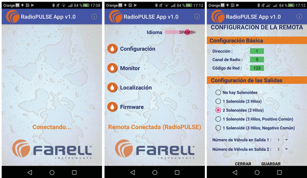
Una vez conectado, escoger **Configuración**. En **Configuración Básica** seleccionar un número de **Canal Radio** y un **Código de Red** que deben coincidir con los empleados en la unidad Maestra. En **Dirección** se entrará un valor de 1 a 8, de 1 a 16 o de 1 a 24 (en función del número máximo de entradas de la Maestra). Cada Unidad Remota deberá tener una **Dirección** diferente
